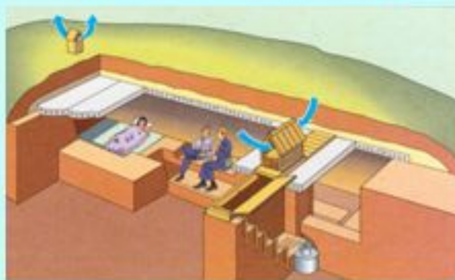
Быстровозводимое ПРУ из железобетонных плит
