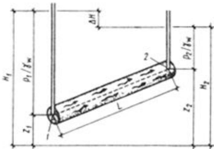
Рис.2.4. Схема фильтрации воды в элементарной трубке грунта
