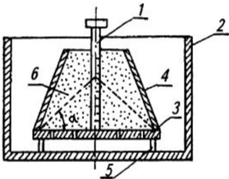
Прибор УВТ-2: 1 — шкала; 2 — резервуар; 3 — мерительный столик; 4 — обойма; 5 — опора; 6 — образец песка
