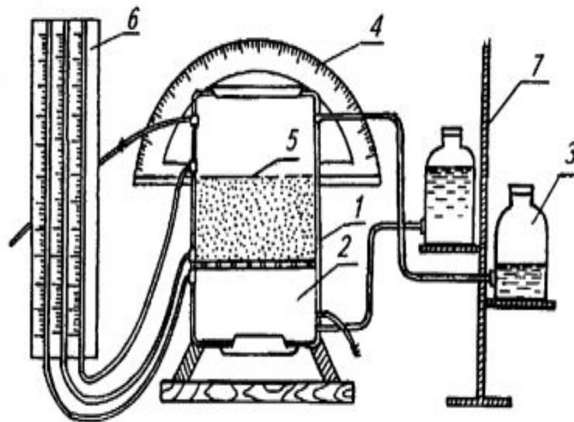
Прибор ВИА: 1 — ящик ВИА; 2 — образец песка; 3 — емкость с водой; 4 — транспортер; 5 — ось вращения; 6 — пьезометр; 7 — штатив
