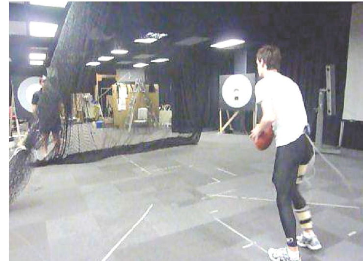
Выполнение движения с регистрацией данных с I-леггинсами и системой сбора данных Optotrak (правая нога) (по R.Helmer, 2011)
