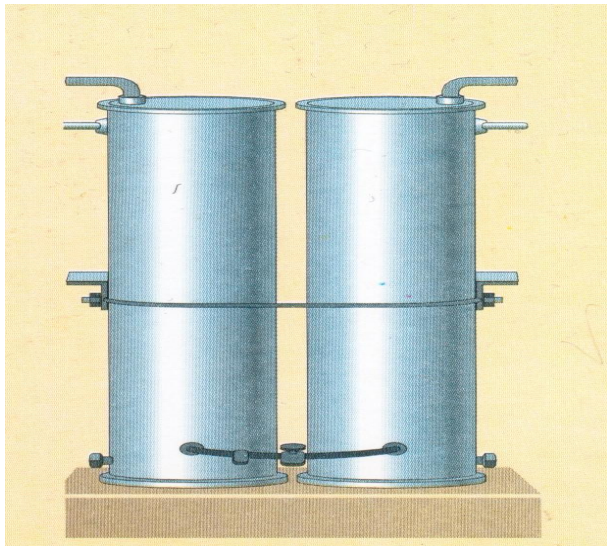
Вертикальный бак аварийного запаса воды
