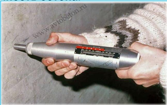
Склерометром определяют прочность бетона на основе его твердости путем царапания по его поверхности.
