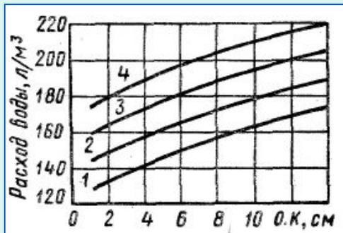
*График для определения водопотребности бетонной смеси на портландцементе:*
