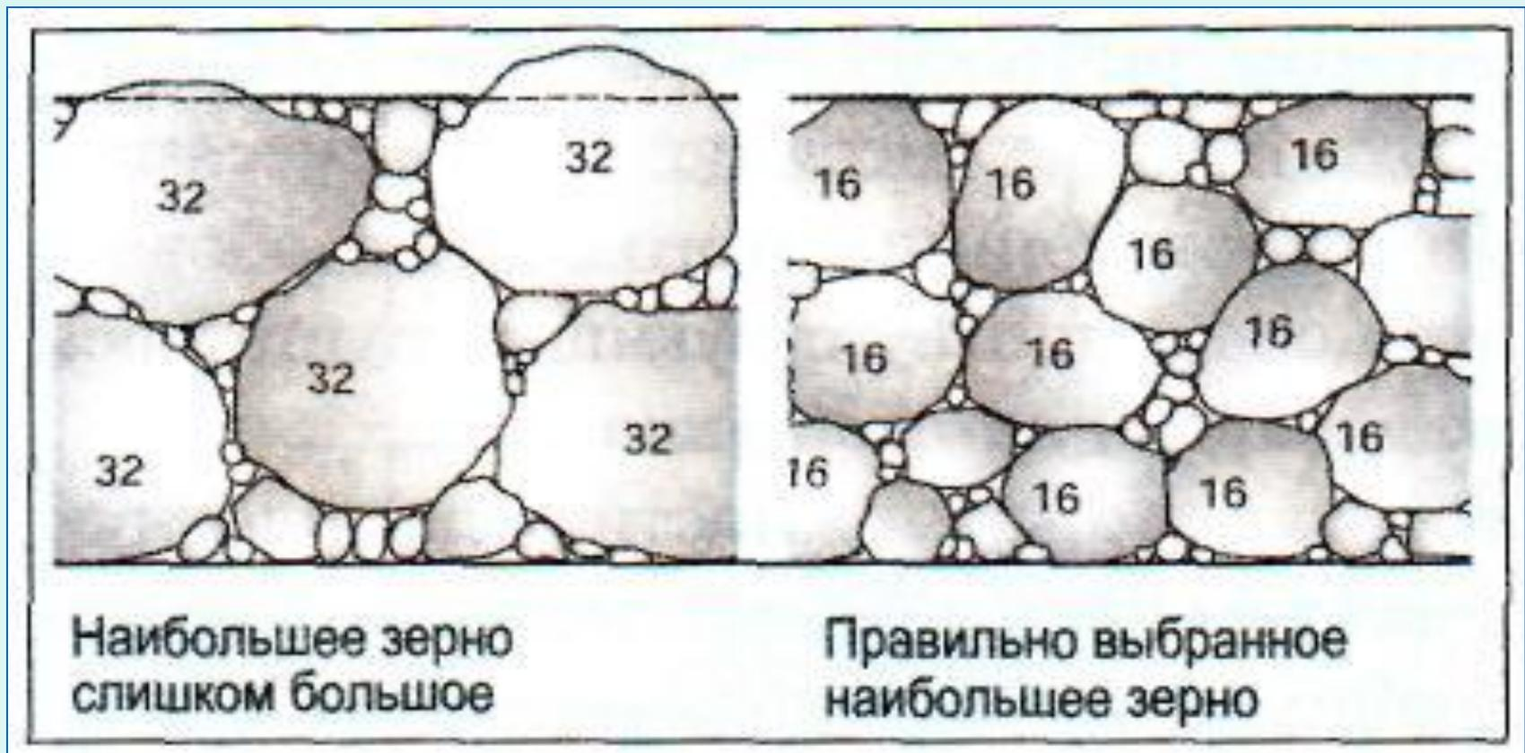
Выбор наибольшего зерна на примере бетонной плиты толщиной 50<sup>11</sup>мм
