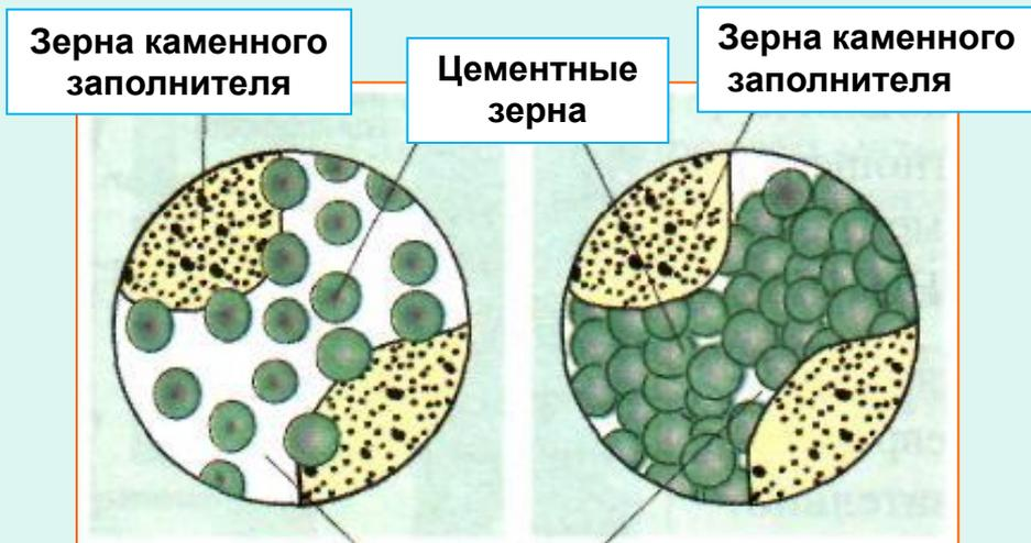
При высоких водоцементных отношениях пространство между двумя цементными зернами так велико, что оно не может быть заполнено при полной гидратации цемента. Остается **ИЗБЫТОЧНАЯ ВОДА**, которая испаряется и оставляет **ПУСТОТЫ**. Эти пустоты, называемые также **ПОРАМИ** или **КАПИЛЛЯРАМИ**.
