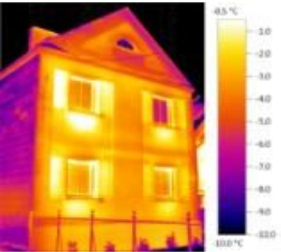
Строительный сектор раскрывает широкий спектр применения всех возможностей термографии. Тепловизоры станут незаменимыми помощниками в ходе быстрой и эффективной локализации тепловых потерь. Тепловизоры позволят с легкостью визуализировать участки некачественной изоляции и тепловые мостики. Они являются идеальными приборами для регистрации и документирования данных по потерям энергии через наружные стены, двери, рольставни, ниши под батареи, крыши и ограждающие конструкции здания в целом.
