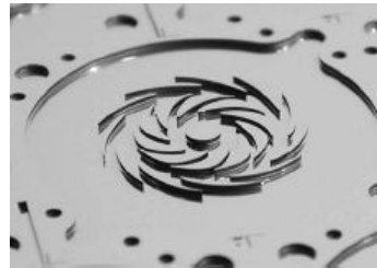
Компрессор D8мм U2 - 500 м\с
