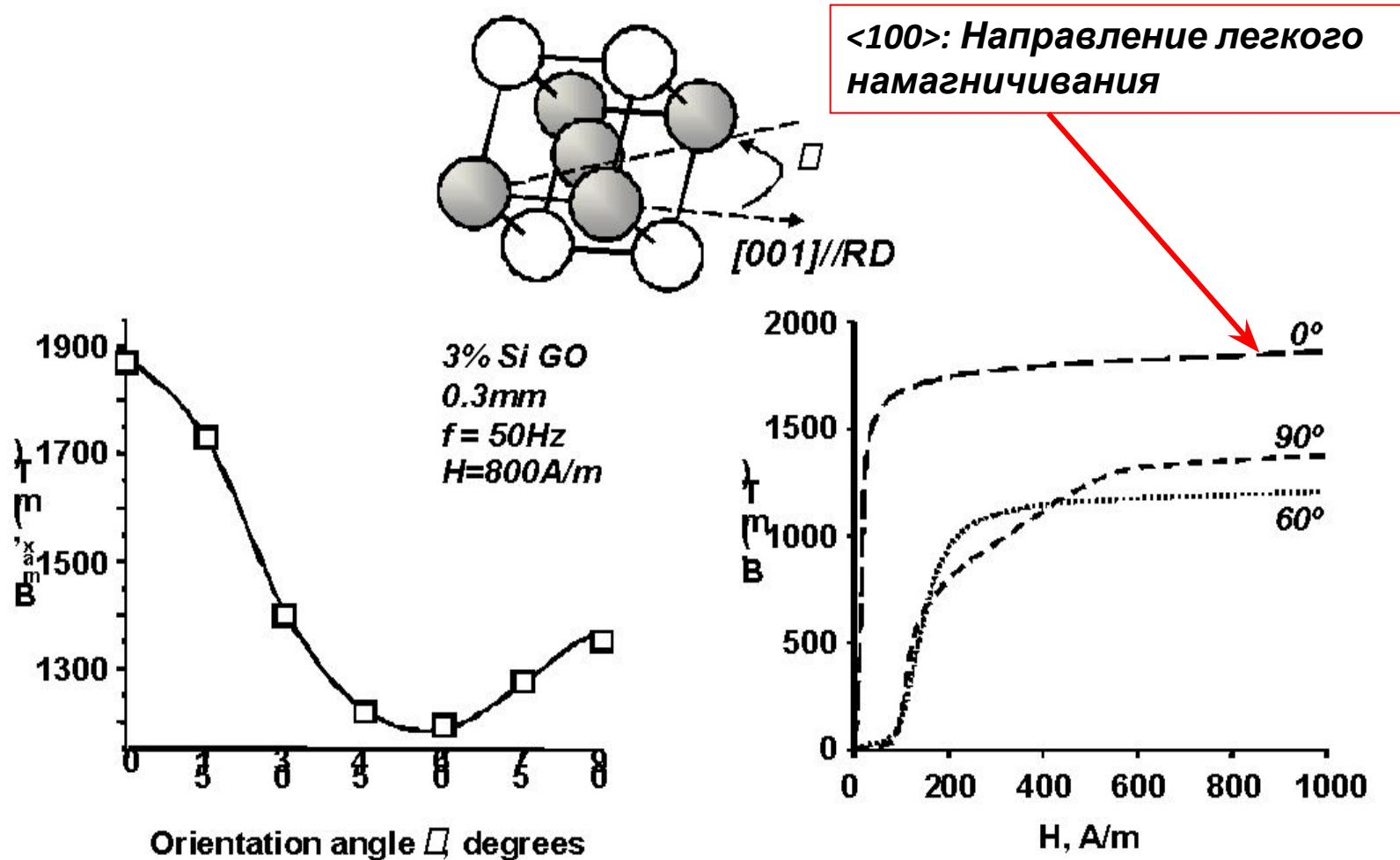
Зависимость магнитных свойств от угла ориентации (3% Si GO electrical steel).
