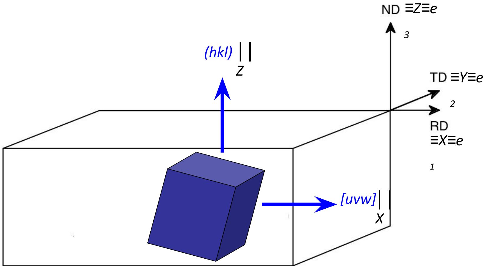
ND (НН) – направление нормали к плоскости прокатки; RD (НП) – направление прокатки; TD (ПН) поперечное к НП и НН направление.
