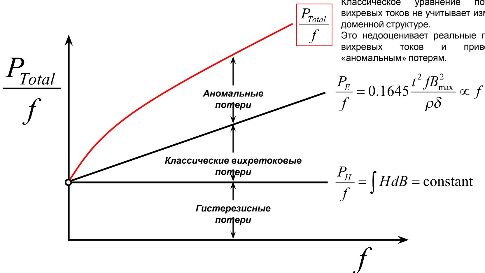
Примечание. Поскольку поле внутри ЭАС уменьшается к центру листа, доменные стенки не остаются плоскими во время изменения поля: часть доменной стенки в центре листа отстает от части стенки на поверхности. Этот эффект более выражен при более высоких частотах и большей толщине.
