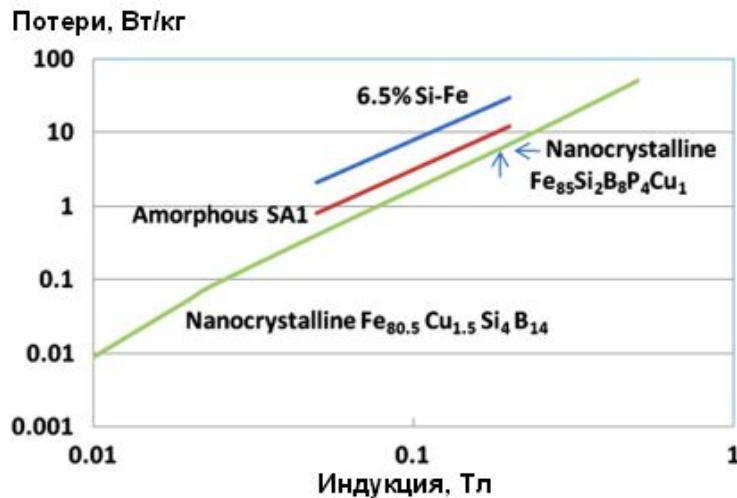
*Электромагнитные потери в зависимости от индукции при частоте 10 кГц для кристаллического 6.5% Si-Fe, аморфного на основе железа и нанокристаллического сплавов*
