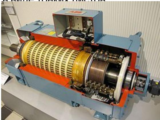
Преобразование механической или тепловой энергии в электрическую энергию (генерация). Большинство генераторов переменного тока используют вращающееся магнитное поле. Принцип действия генератора основан на законе электромагнитной индукции – индуцирование электродвижущей силы в прямоугольном контуре (проводочной рамке), находящейся в однородном вращающемся магнитном поле.
