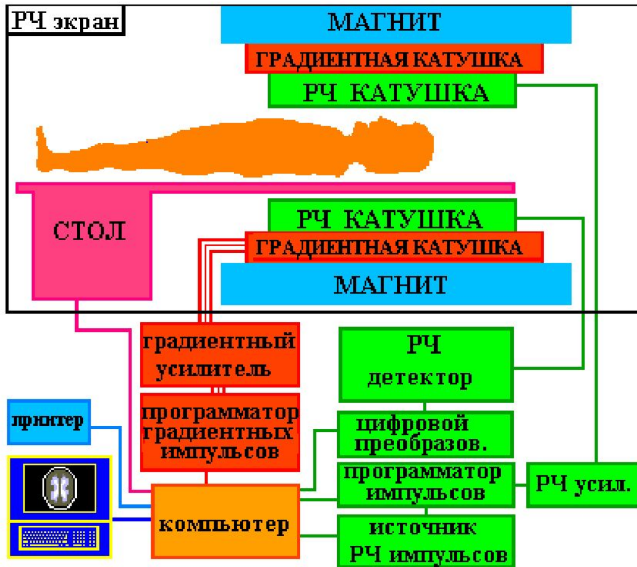
Схема основных систем МР томографа
