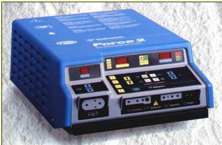
Аппарат для электрохирургии Частота излучения 0.2-5.5 МГц Мощность до 100 Вт
