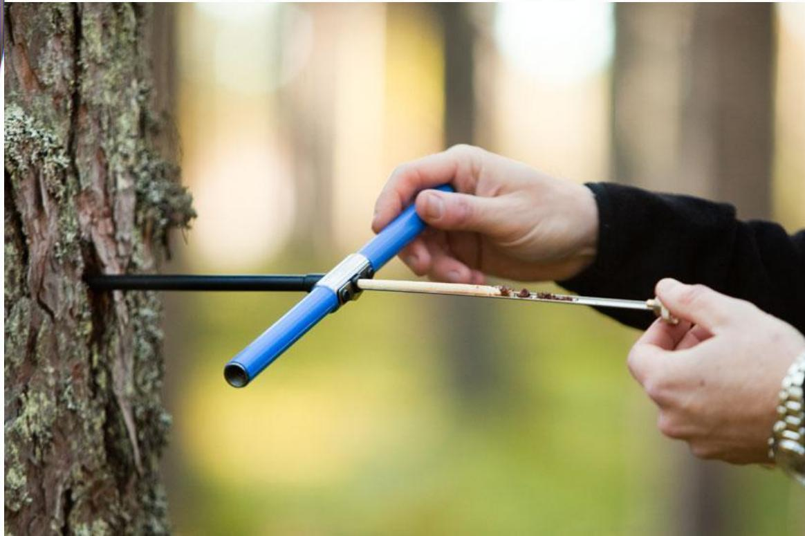
Возрастной бурав – прибор для определения возраста растущих деревьев. Определение возраста имеет большое практическое значение: он нужен для установления спелости леса и возраста его рубки, назначения различных лесохозяйственных мероприятий, рубок ухода.
