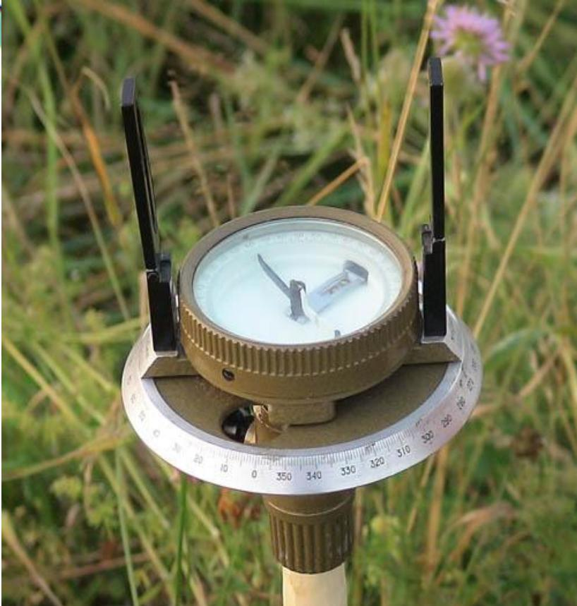
Наземная геодезическая съемка активно применяется в лесном хозяйстве при инженерных изысканиях трасс лесовозных дорог, подготовке планов лесовосстановительных работ, разработке планов рубок и подготовке отводов лесосек, оценке ущерба лесов в результате последствий стихийных бедствий. Как и много лет назад, так и сегодня основным угломерным инструментом в руках лесоводов продолжает оставаться буссоль.
