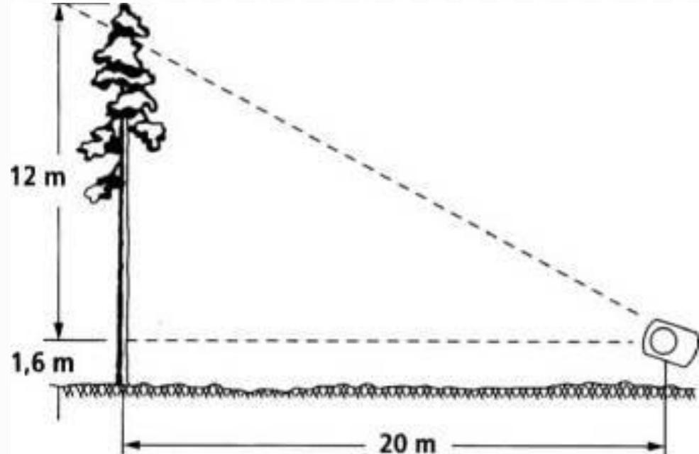
Высота дерева – расстояние от основания дерева до конца вершины, выражается в метрах. Высотомер позволяет с базового расстояния определить высоту дерева.
