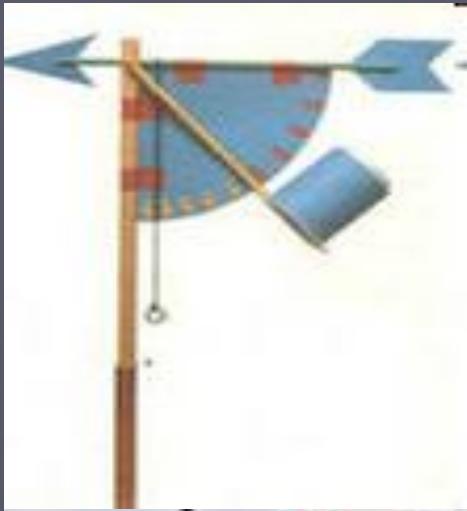
Анемометр-прибор для измерения скорости ветра
