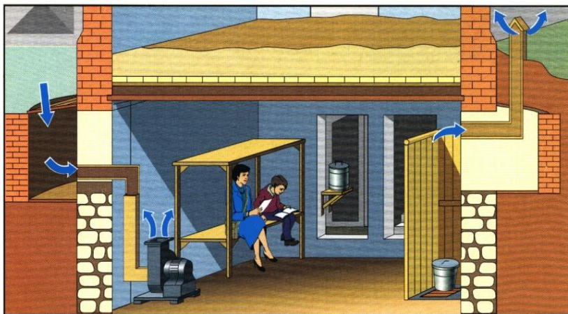
Подвал одноэтажного здания, приспособленный под противорадиационное укрытие
