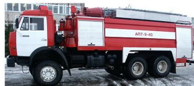
Пожарный автомобиль пенного тушения (АПТ)
