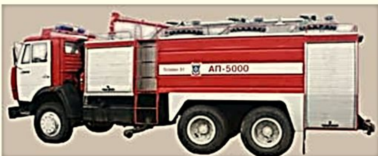
Пожарный автомобиль газового тушения (АГТ)
