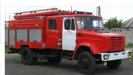
Пожарный автомобиль насосно-рукавный (АНР)
