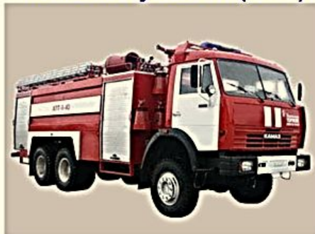
Пожарный автомобиль пенного тушения (АПТ)
