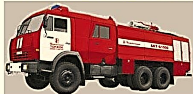
Пожарный автомобиль газоводяного тушения (АГВТ)
