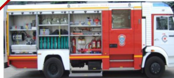
шесть боковых отсеков оборудования, по три с правой и левой сторонах пожарной автоцистерны.
