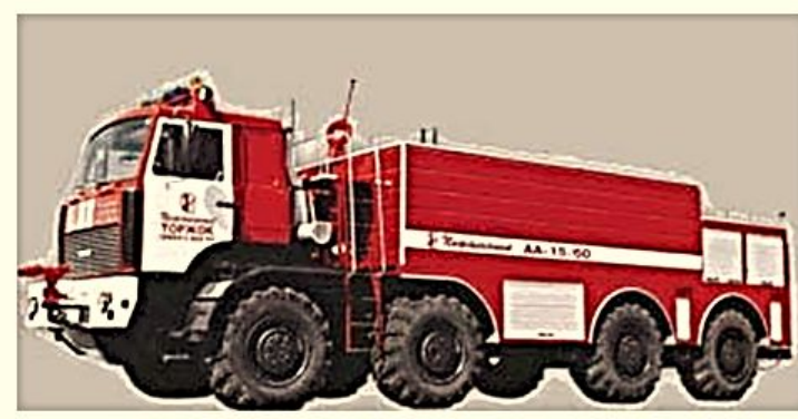
Пожарный аэродромный автомобиль (АА)
