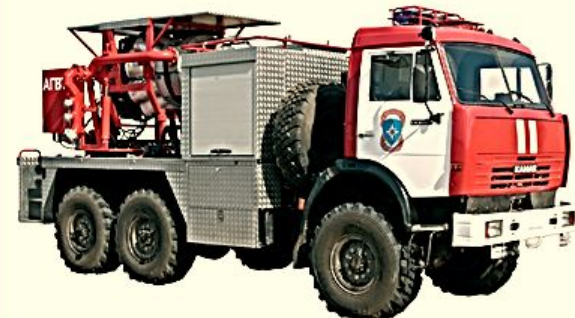
Пожарный автомобиль газоводяного тушения (АГВТ)
