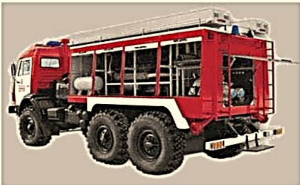
Пожарная автонасосная станция (ПНС)
