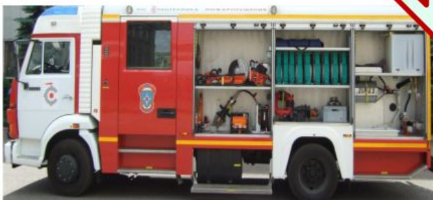
шесть боковых отсеков оборудования, по три с правой и левой сторонах пожарной автоцистерны.
