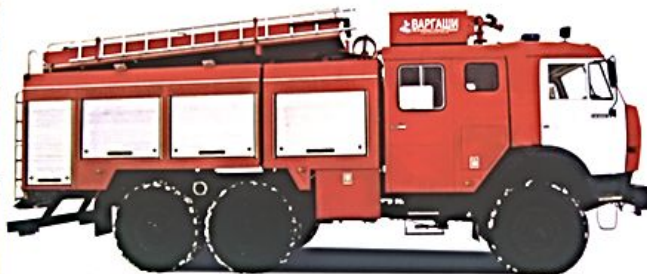
Пожарный автомобиль быстрого реагирования насосно-рукавного типа ПАБР 2,0-20/200 (43118)-31ВР
