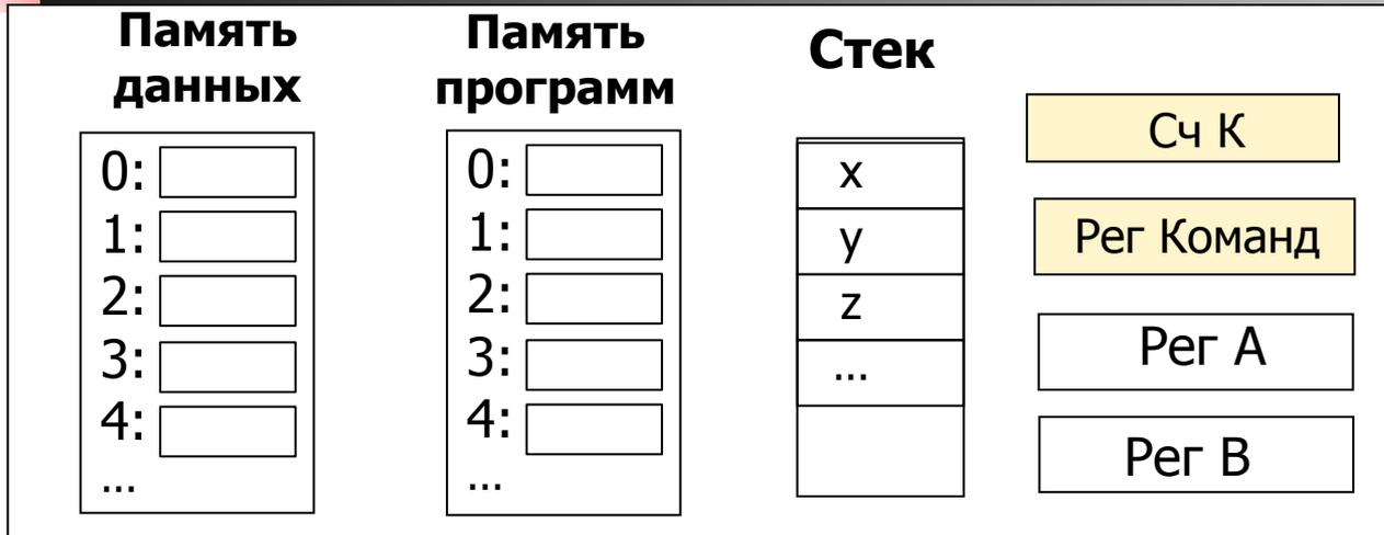
■ Стековая машина – Виртуальный однопроцессорный компьютер с простой архитектурой. Содержит:
