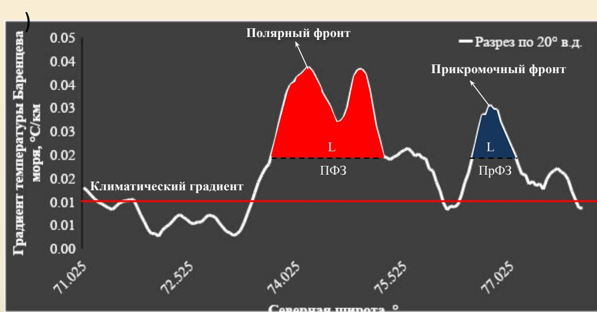
Рис. 4 Визуальное представление методики выделения фронта: а) композитная карта градиентов и изолиний температур поверхности совместно с проведенными разрезами. б) оценка количественных характеристик двух выделенных фронтальных разделов: ПФЗ – Полярная фронтальная зона (красный цвет), ПрФЗ – Прикромочная фронтальная зона (синий цвет), L – ширина фронтальной зоны, фронт- максимальный градиент ТПМ.
