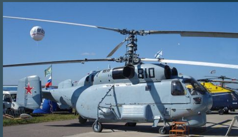
Вертолет Ка-32 с двумя соосными несущими винтами
