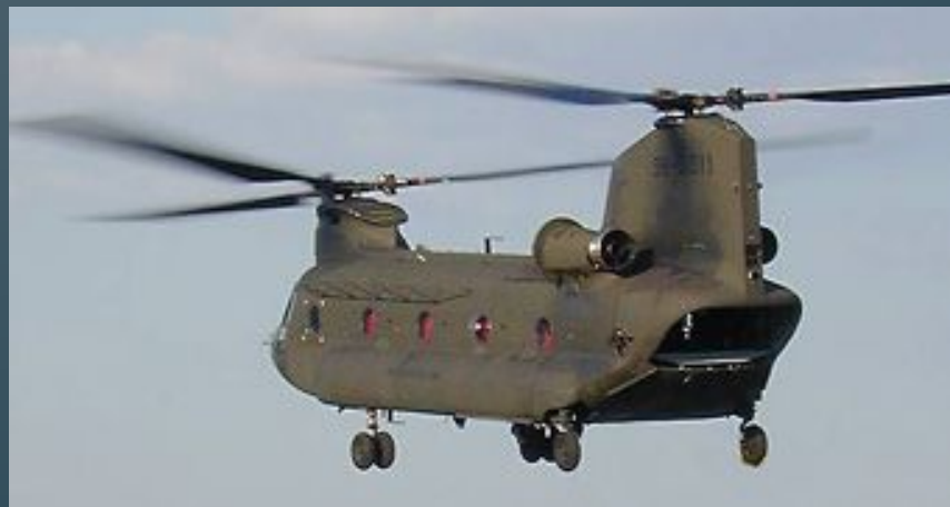
Вертолет СН-47 с двумя несущими винтами
