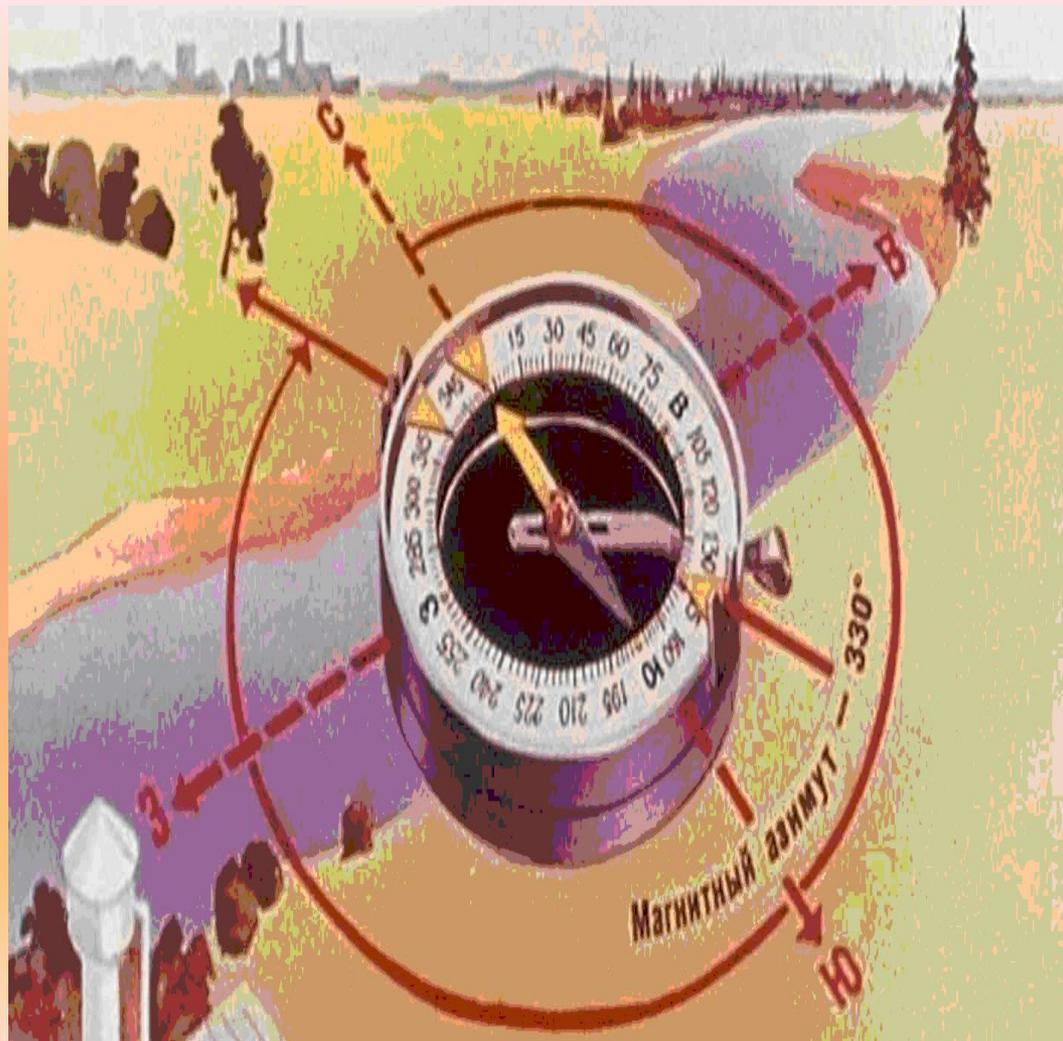
Для получения магнитного азимута держите компас горизонтально в левой руке. Вращая корпус компаса, добейтесь совпадения северного конца стрелки с нулевой отметкой шкалы. Затем вращайте кольцо с визиром до совпадения линии взгляда с удаленным и хорошо видимым предметом, строением или деревом. Произведите отсчет азимута на этот предмет. Отсчет делайте от нулевого значения шкалы по часовой стрелке до цифры на шкале, расположенной напротив указателя визира.
