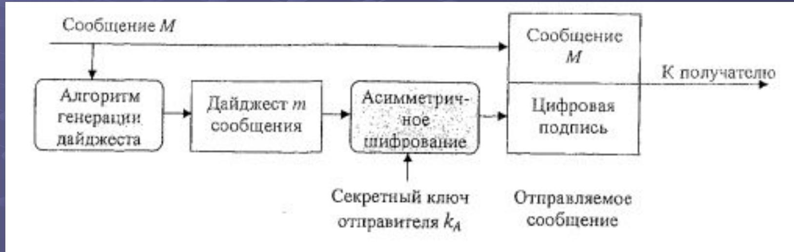
Рисунок 1 – Схема формирования электронной цифровой подписи
