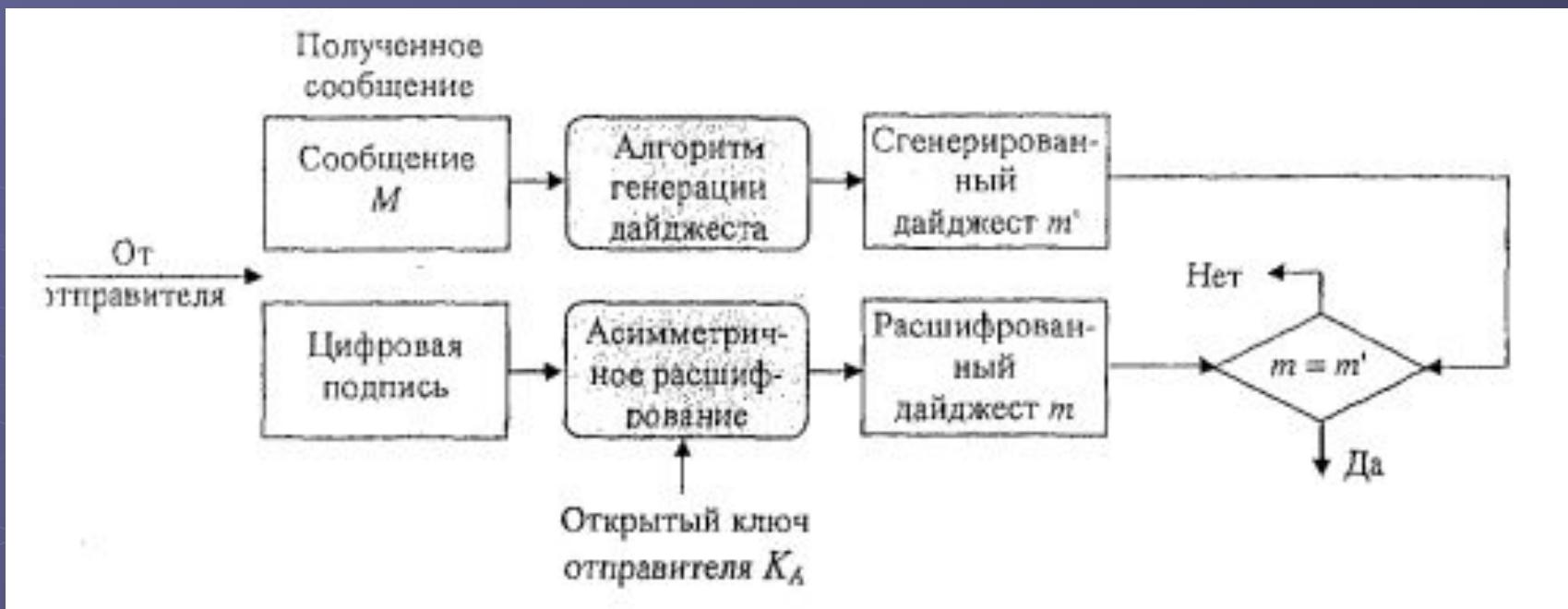
Рисунок 2 - Схема проверки электронной цифровой подписи
