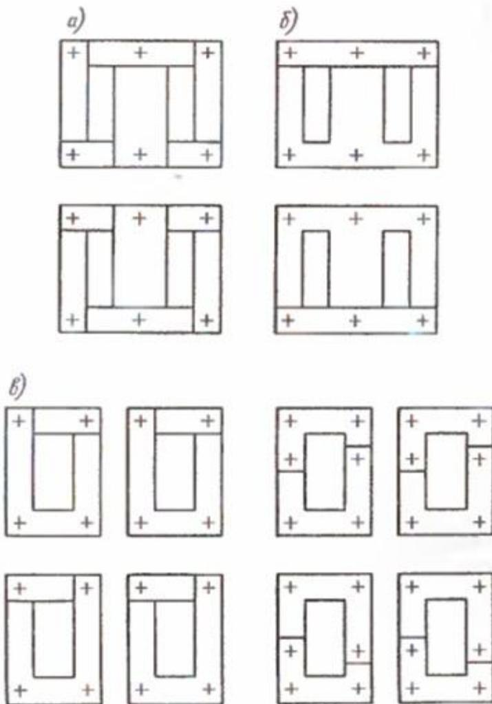
Шихтованные магнитопроводы: а – из прямоугольных пластин;
