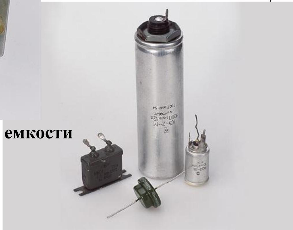
**Конденсатор постоянной емкости**
