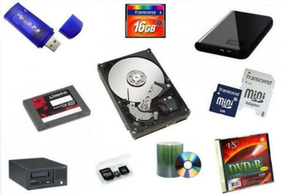
**Внешняя память** предназначена для долговременного и энергонезависимого хранения программ и данных. К одному компьютеру можно подключить несколько устройств внешней памяти.
