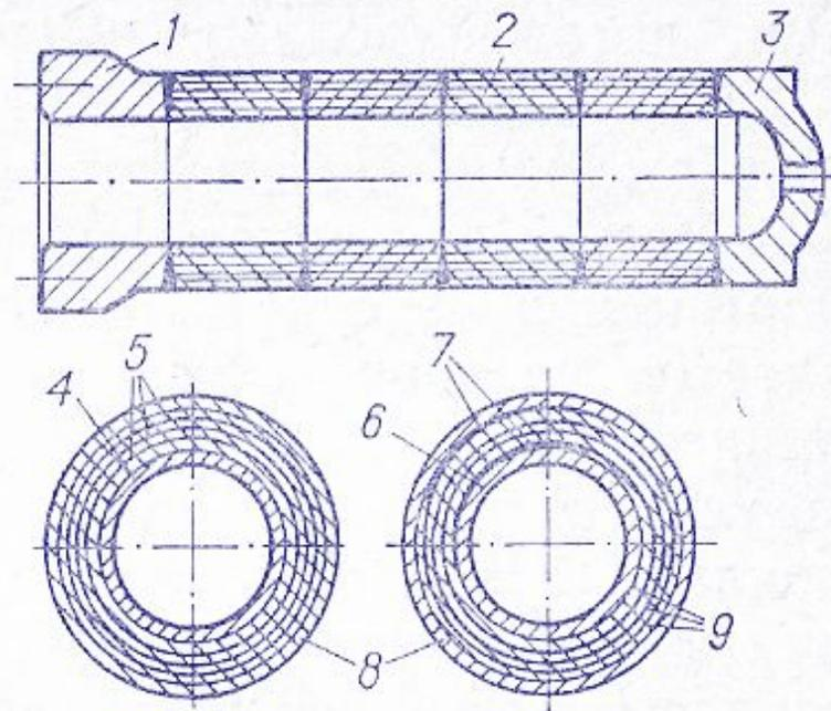
Слева направо: Рис. 4. Корпуса аппаратов высокого давления: а — тип ГД; б — тип ЦЦ.
