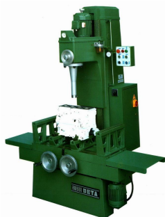
Станок для расточки блоков цилиндров ЛТ-520
