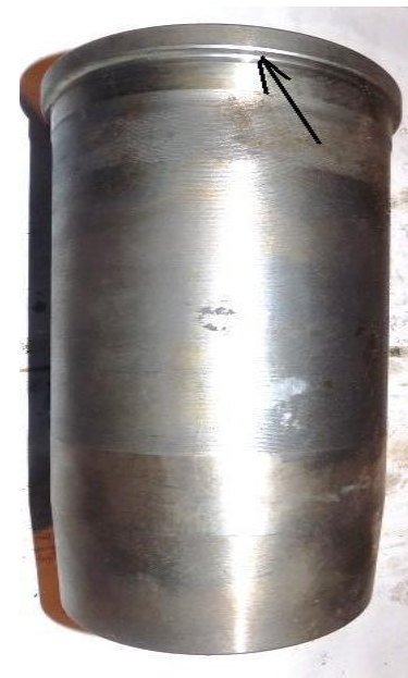
Износ опорного буртика гильзы
