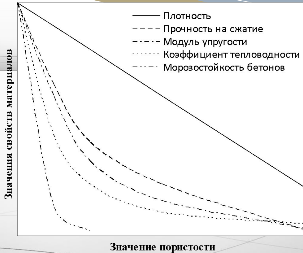
Рис. 6.12. Зависимость свойств материалов от пористости.
