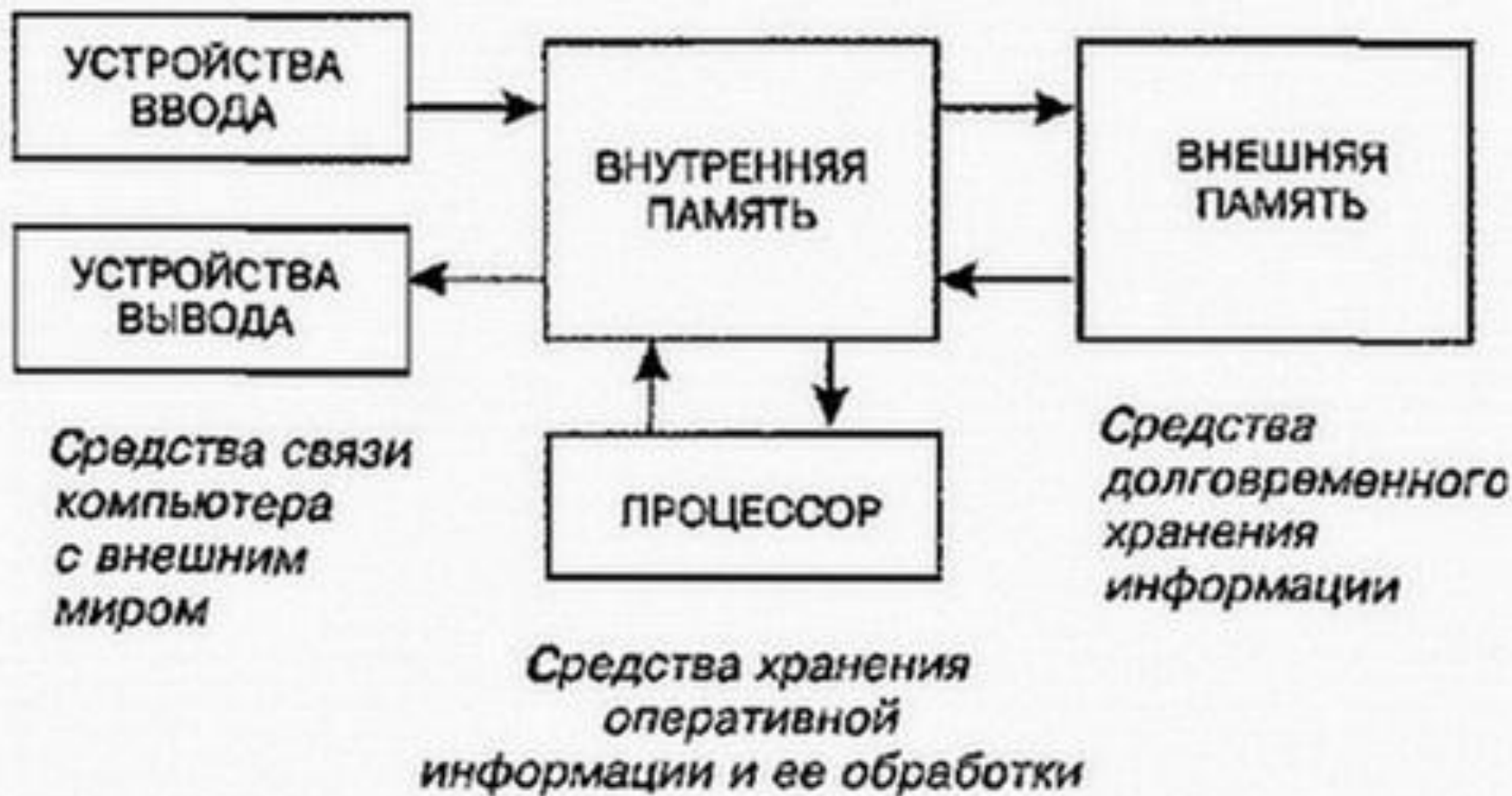
Рис. 2.3. Схема устройства компьютера
