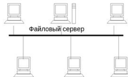
рис.3 Структура логической кольцевой цепи
