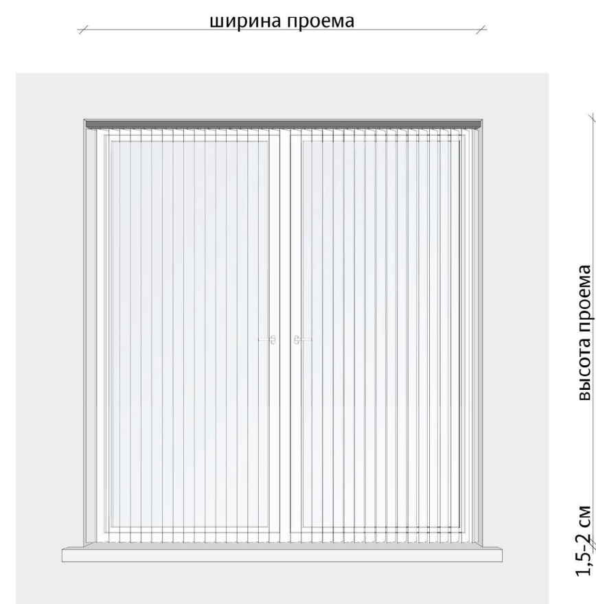
Установка жалюзи в оконном проеме
