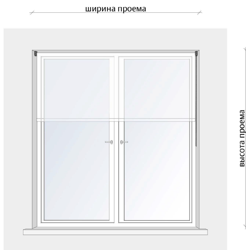
Установка рулонных штор в оконном проеме
