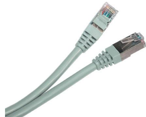
Патч-корд, RJ45-RJ45, кат.5Е, 4 пары, FTP
