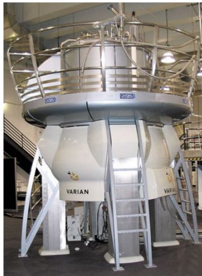
Магнит спектрометра Varian 900 МГц
