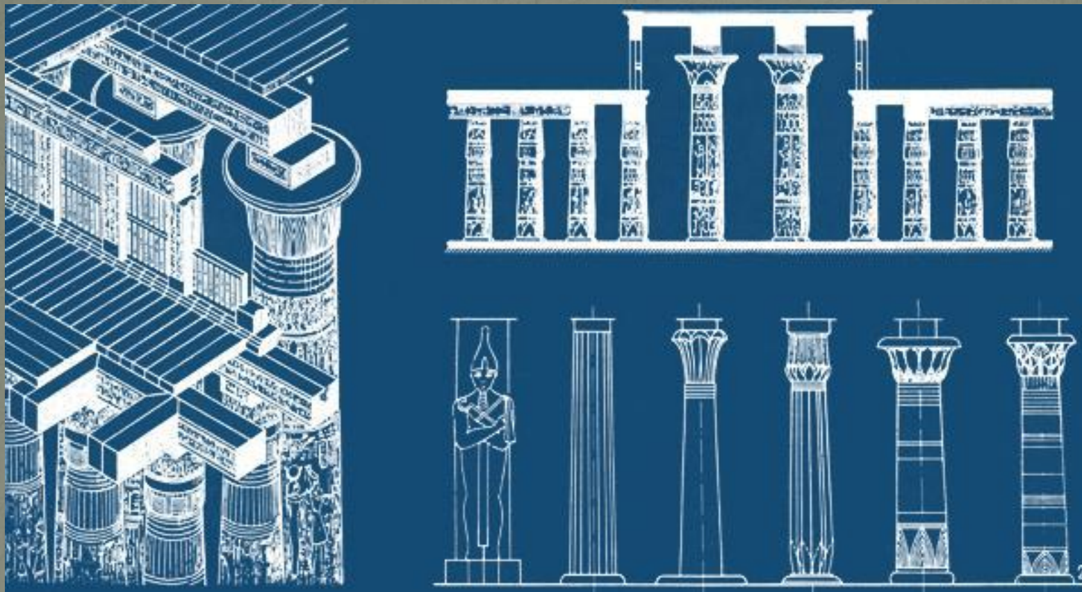
Стойчно-балочные конструкции в Древнем Египте.
