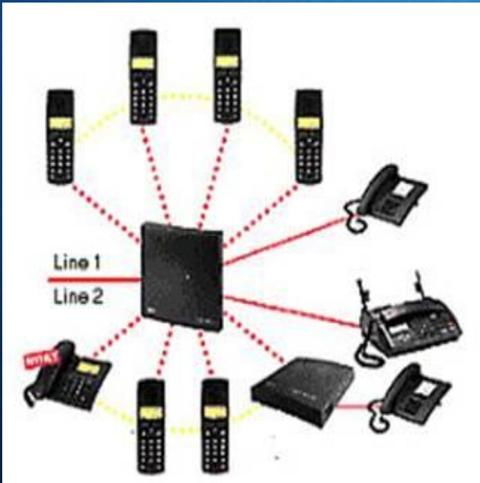
Классическая Home System состоит из одного базового блока, подключаемого обычно через обыкновенную аналоговую линию (1 или 2 линии). Устанавливается обычно в частных квартирах. Доступно к подключению до 8–10 мобильных трубок. Обеспечивают в рамках одной базы 2 соединения между 2 трубками и 1 соединение между одной трубкой и аналоговой линией одновременно.
