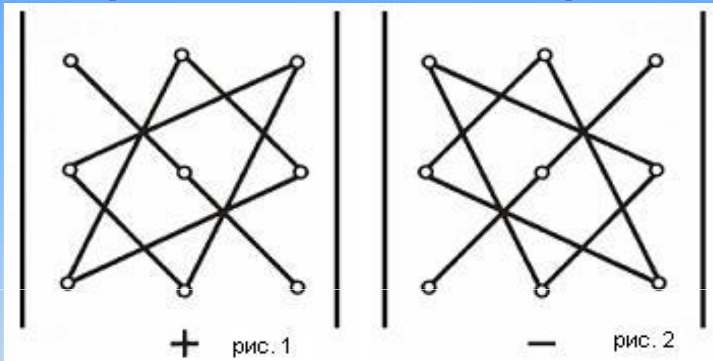
По схеме рис.1. произведения соединенных элементов берутся со своим знаком, а по схеме рис. 2 - с обратным. Величина определителя равна алгебраической сумме полученных шести произведений.
