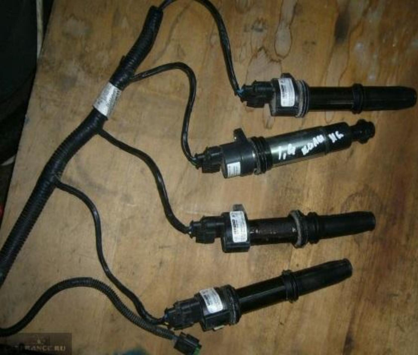
Вполне электронная "статическая" система зажигания, когда катушка зажигания каждого цилиндра управляется своим выходным каскадом контроллера, позволяет не совсем лишь выдавать на свечи зажигания ток высочайшего напряжения, достигающего 32 кВ, но и живо изменять угол опережения зажигания в каждом цилиндре. Не считая того, спектр регулирования угла опережения зажигания увеличен приблизительно на  $10^\circ$  и сочиняет  $59^\circ$  (по коленчатому валу) для каждого цилиндра.
