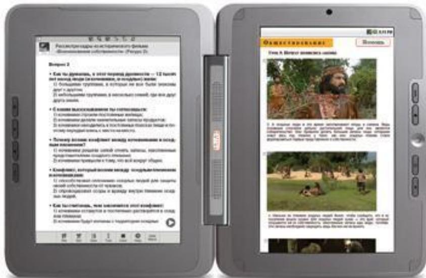
Данное устройство представляет собой два соединенных и связанных между собой экрана – жидкокристаллический и основанный на технологии e-Ink, или электронных чернил.
