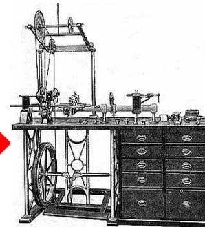
токарный станок Модсли (стандарт. детали)
