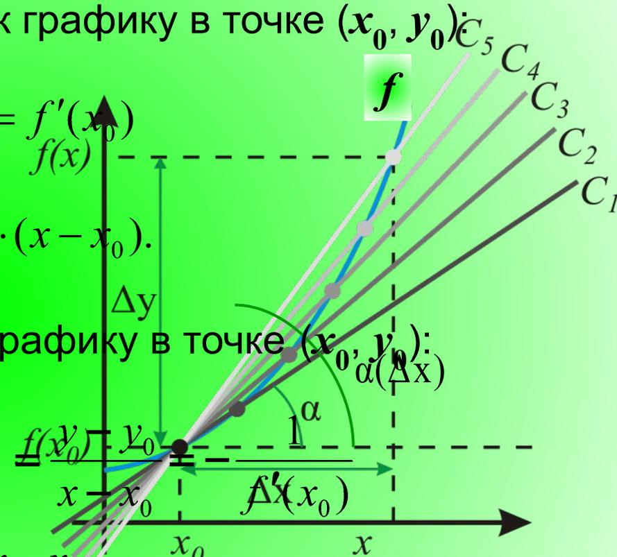
**Тангенс угла  $\alpha$  наклона этой касательной** – и есть **производная функции  $f$  в точке  $x_0$** .
