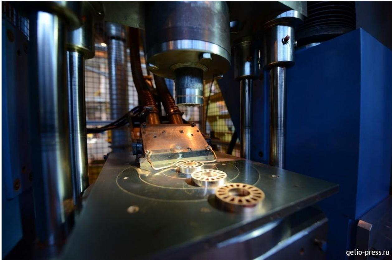
Изделия или заготовки (блоки) получают **прессованием** в стальных пресс-формах под давлением 100-300 МПа при комнатной температуре. Далее изделия подвергают высокотемпературному обжигу (1200-1300 °С). При обжиге происходит спекание исходных материалов и цементация их с коксом, образующимся из связующих органических веществ.
