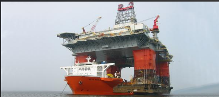
Транспортировка платформы Лун-А к месту установки
