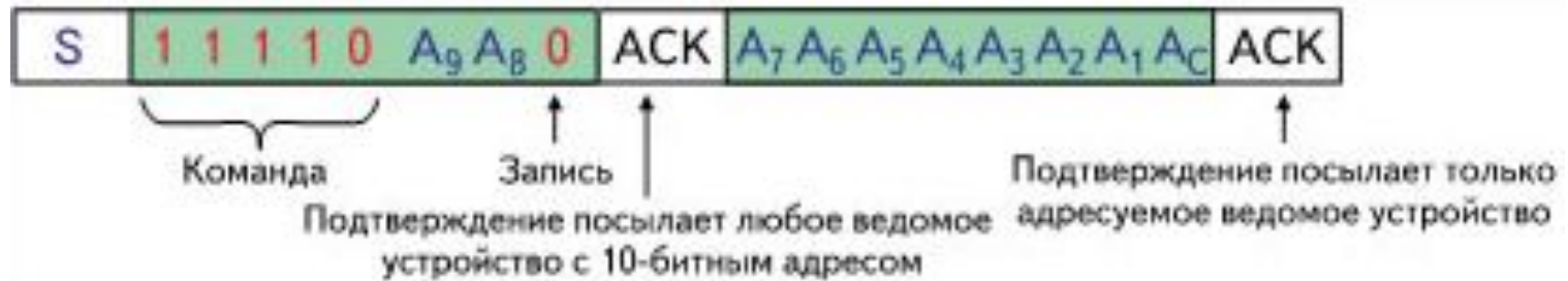
Рисунок 28 – 10-и битный формат протокола I 2 C
