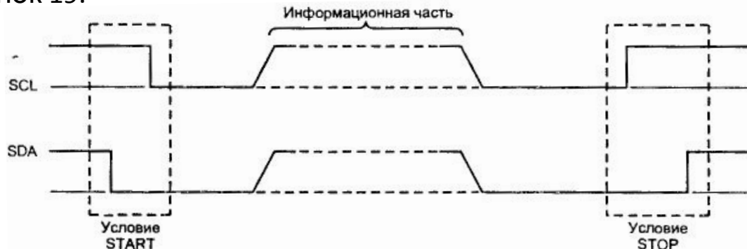
Рисунок 19 – Информационный пакет данных на шине I 2 C
