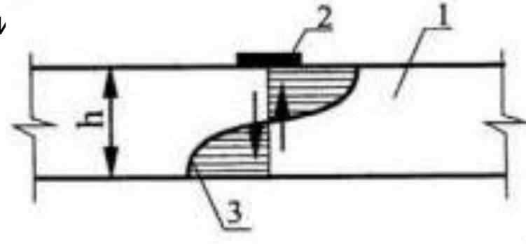
Рисунок 3 - Схема измерения толщины резонансным методом; 1 - исследуемая деталь; 2 - пьезоэлемент; 3 - совпадающие амплитуды прямой и обратной «стоячей» волны;  $h$  - толщина детали
