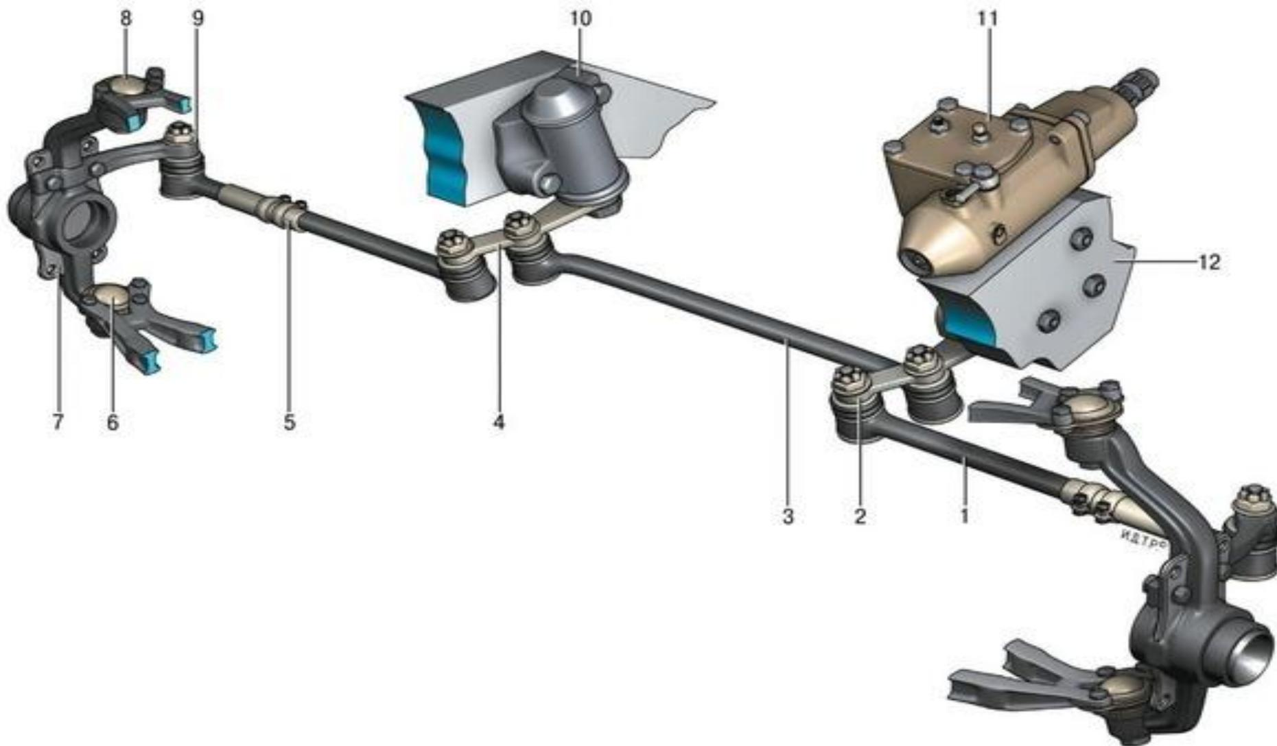
Рулевым усилителем называется механизм, создающий под давлением жидкости или сжатого воздуха дополнительное усилие на рулевой привод, необходимое для поворота управляемых колес автомобиля. Он служит для облегчения управления автомобилем, повышения его маневренности и безопасности движения, а также смягчает толчки и удары дорожных неровностей, передаваемых от управляемых колес на рулевое колесо.
