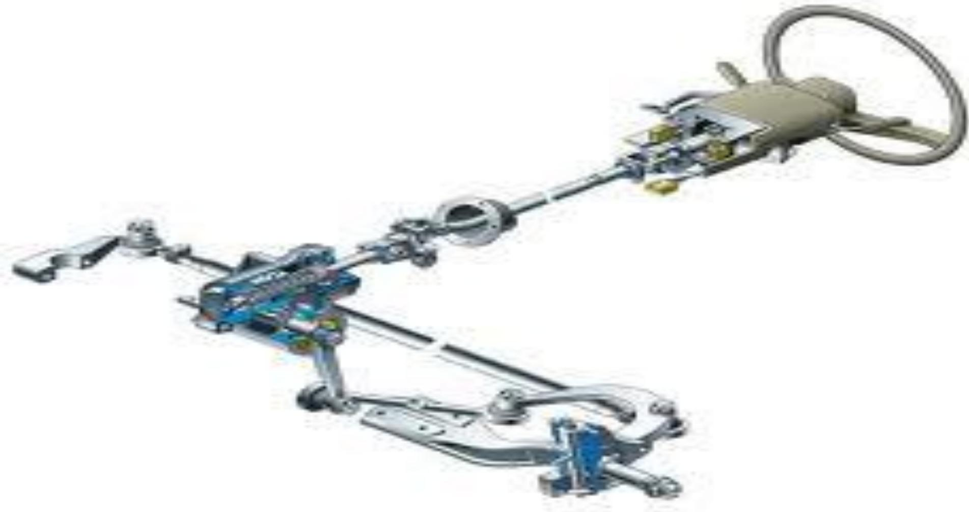
Применение рулевого привода с передней или задней рулевой трапецией зависит от компоновки автомобиля и его рулевого управления. При этом рулевой привод может быть с неразрезной или разрезной рулевой трапецией в зависимости от типа подвески.
