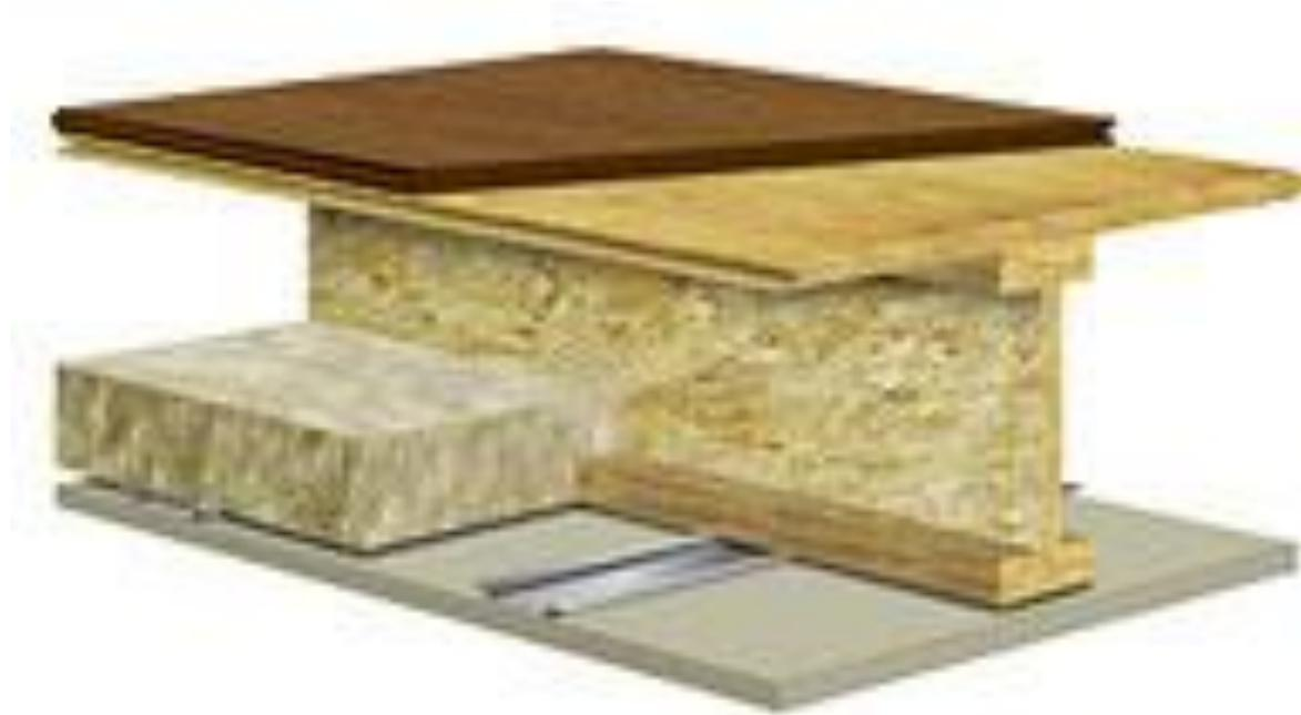
Обшивки из асбестоцементных плоских листов или ЦСП крепят к деревянному каркасу шурупами (саморезами). Отверстия под шурупы в листах должны быть диаметром большим, чем диаметр шурупа. Совместность работы листов и ребер не учитывают в запас несущей способности.
