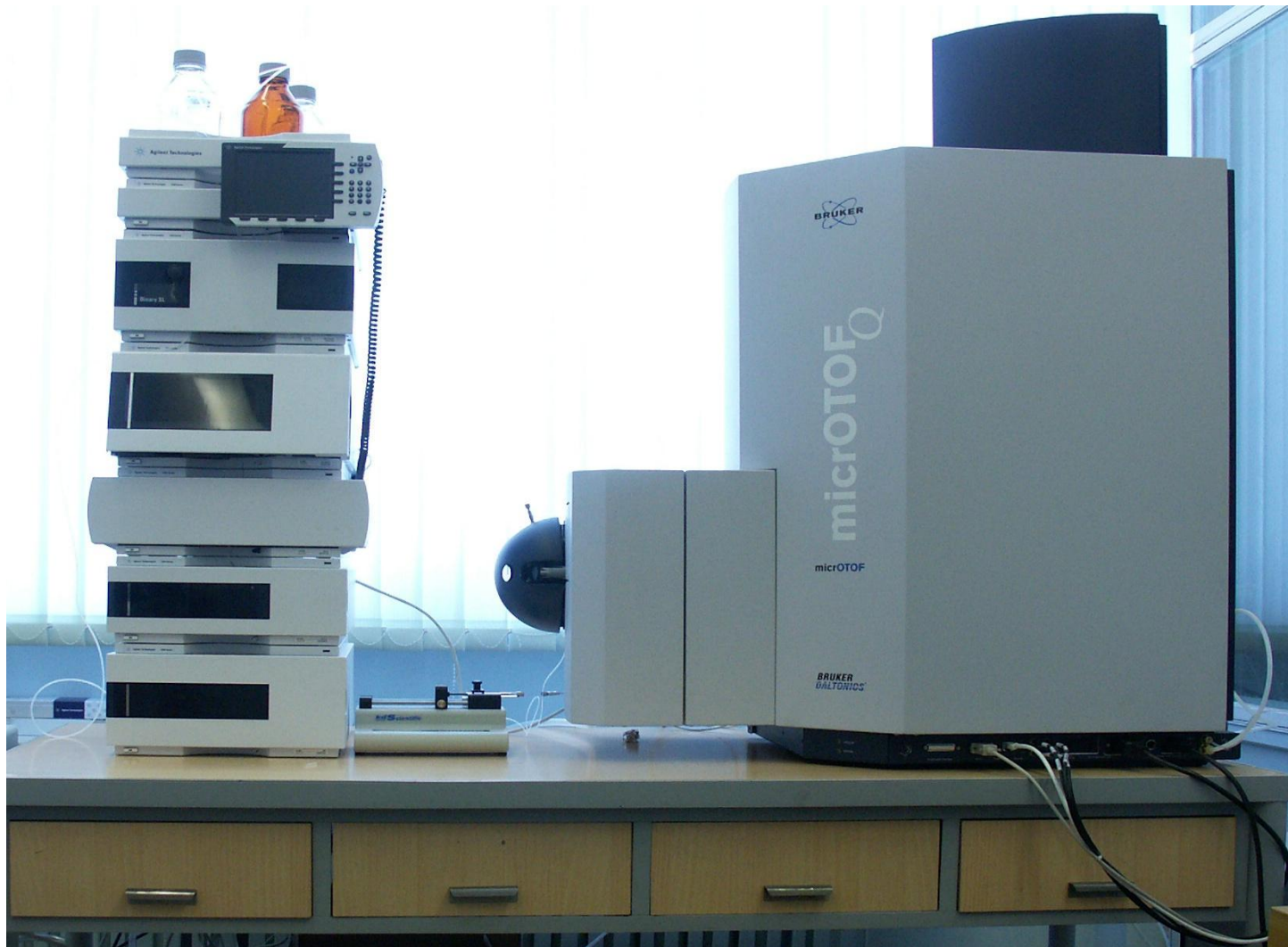
Рис. Времяпролетный масс-спектрометр высокого разрешения Bruker microTOF Q с жидкостным хроматографом Agilent 1100
