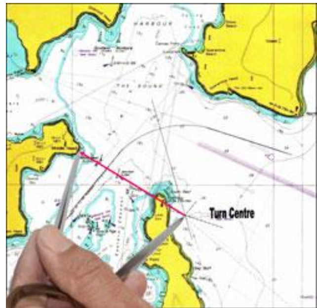
малюнок 3 – виміряємо відстань від опорної точки до центру повороту
