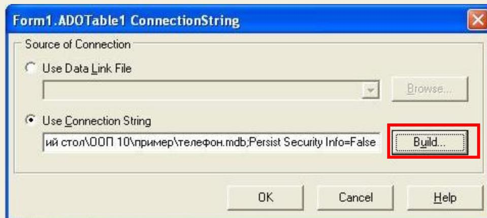
2. Открывается окно связи с данными, в котором на вкладке **Поставщик** данных выбираем **Microsoft Jet 4.0 Ole DB Provider**
