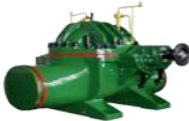
Нефтяные магистральные насосы типа НМ – предназначены для перекачивания нефти и нефтепродуктов с температурой от -5 до 80<sup>0</sup>С с содержанием механических примесей не более 0,05% по объему, размером частиц до 0,2мм. проектирования цеховых сетей, выбора
