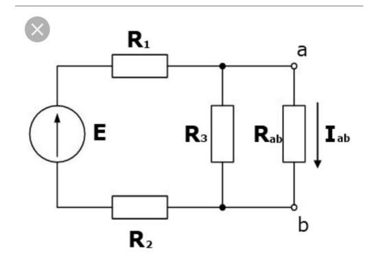
Метод эквивалентного генератора используется при расчёте сложных схем, в которых одна ветвь выделяется в качестве сопротивления нагрузки, и требуется исследовать и получить зависимость токов в цепи от величины сопротивления нагрузки.
