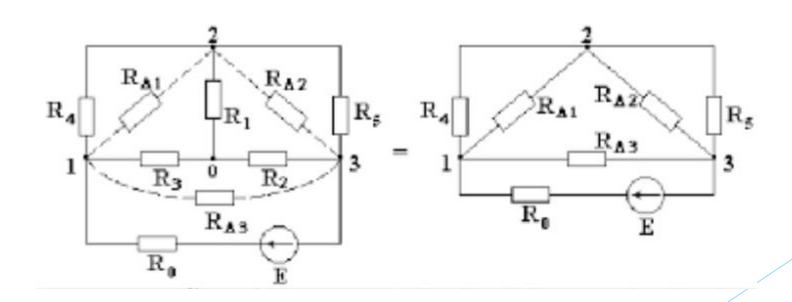
Суть метода эквивалентного генератора состоит в нахождении тока в одной выделенной ветви, при этом остальная часть сложной электрической цепи заменяется эквивалентным ЭДС Еэкв, с её внутренним сопротивлением гэкв. При этом часть цепи, в которую входит источник ЭДС называют эквивалентным генератором или активным двухполюсником, откуда и название метода. Этим методом удобно рассчитывать ток в одной ветви, особенно, если сопротивление этой ветви меняется.
