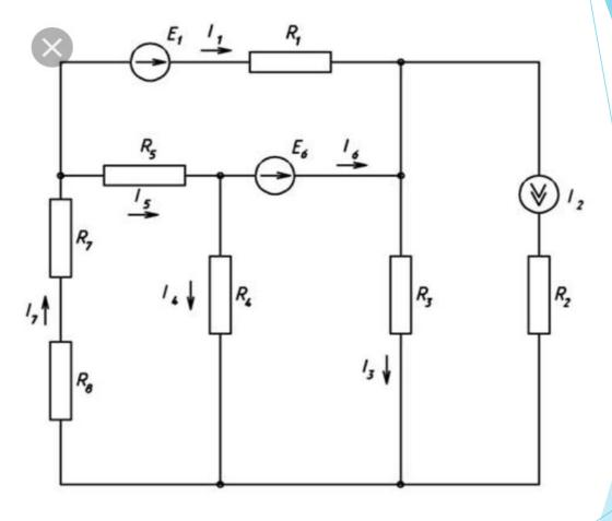
Метод эквивалентного генератора, основанный на теореме об активном двухполюснике ( называемой также теоремой Гельмгольца-Тевенена), позволяет достаточно просто определить ток в одной ветви сложной линейной схемы, не находя токи в остальных ветвях. Применение данного метода особенно эффективно, когда требуется определить значения тока в некоторой ветви для различных значений сопротивления в этой ветви в то время, как в остальной схеме сопротивления, а также ЭДС и токи источников постоянны.
