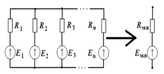
Для определения эквивалентного сопротивления генератора применятся расчет последовательно и параллельно соединённых сопротивлений, а также, в случае более сложных схем, применяют преобразование треугольник-звезда.
