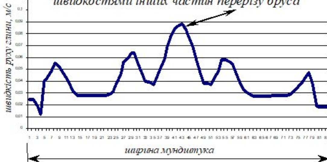
Рисунок 5 – Модель мундштука та візуалізація "заливка швидкість" на виході
