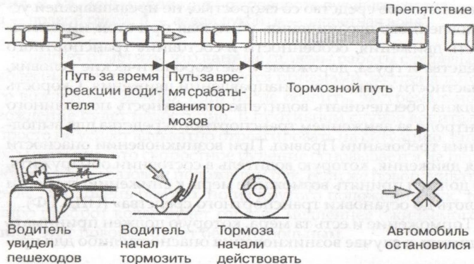
Рис. 2.13. Этапы остановочного пути и схема действий водителя
