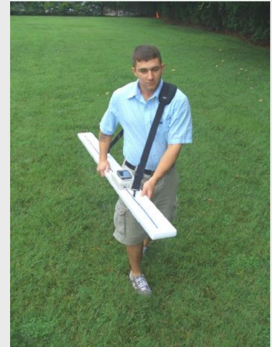
GEM-2 (США) для ДИП и магн. восприимч. от Georhex. Измеряет \sigma и k
